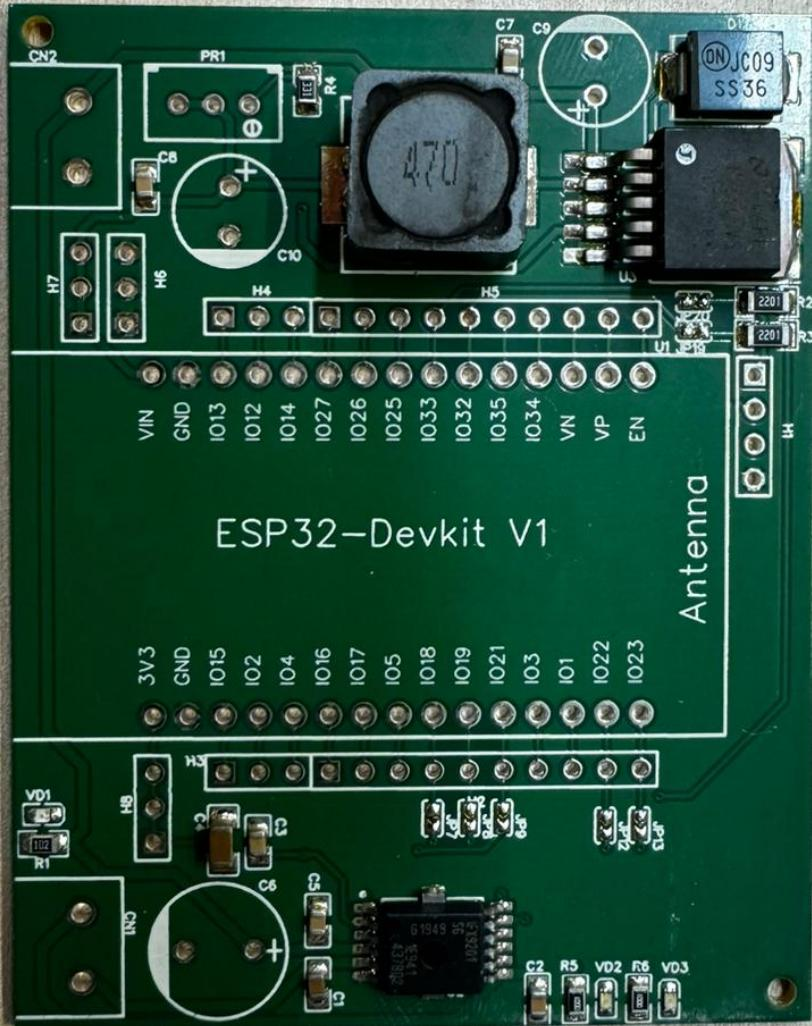
Soldering-ul a fost unul foarte usor si placut. SMD-urile au fost lipite cu ajutorul unui Stencil si pasta, la final bagate intr-un cuptor. (driverul de motor si integratul buck converter-ului au pad-uri foarte mari de masa, iar pentru aceasta a fost nevoie de un cuptor.
