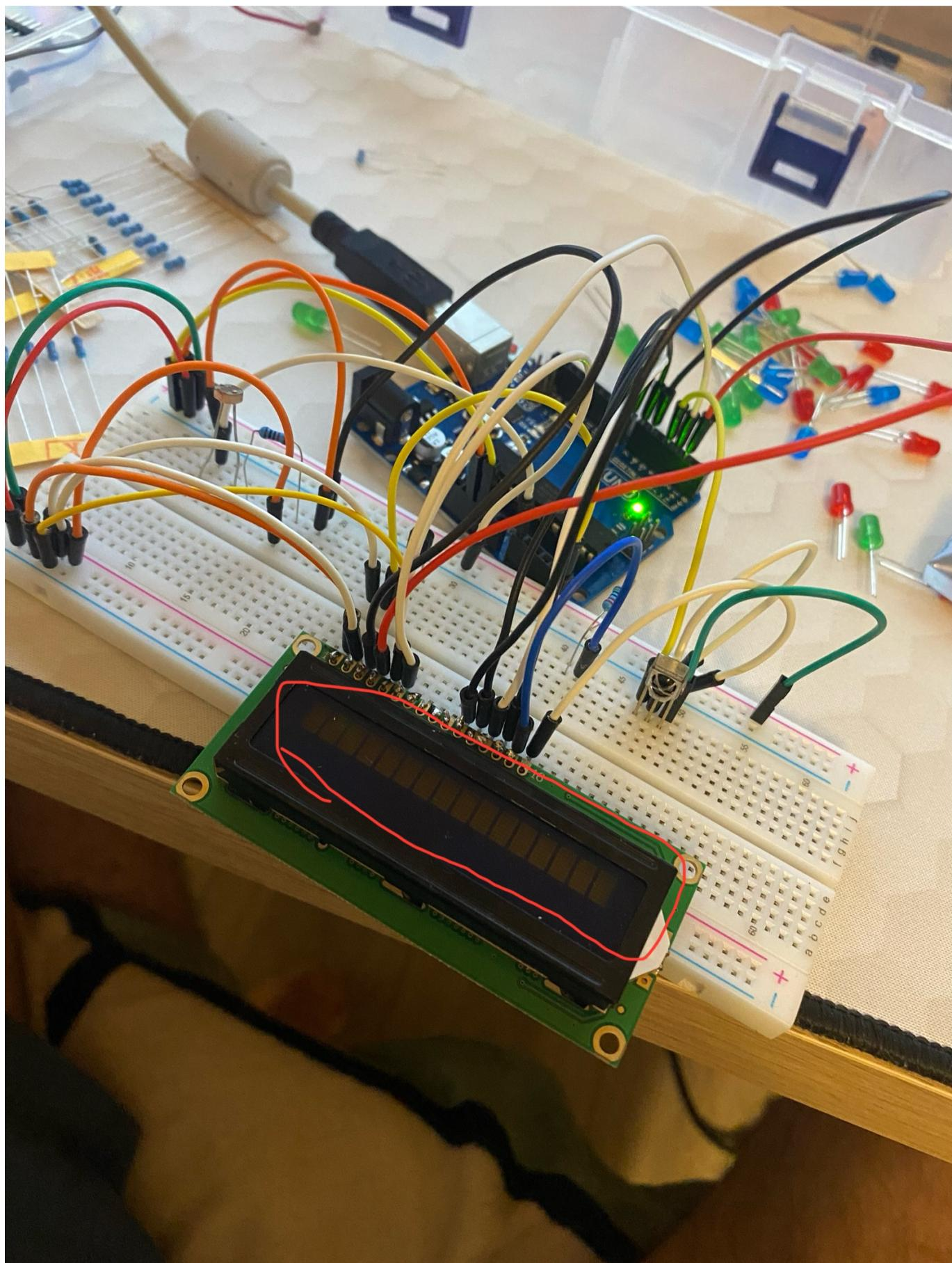
Versiunea Beta, dupa refacerea conexiunilor ecranului LED, un potentiometru, senzor de temperatura si fotorezsitor noi, intreg sistemul functioneaza insa trebuie slefuit din punct de vedere software.
