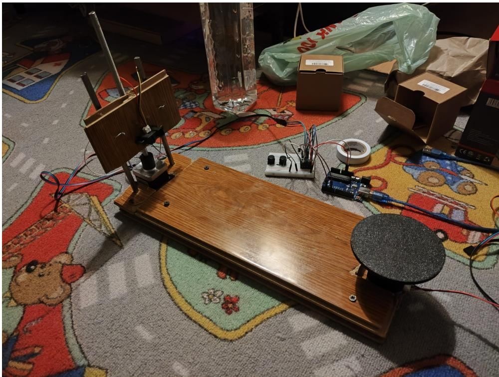
Desi nu am putut testa codul final deoarece proiectul nu este in stare functionala din cauza ansamblului care ar fi trebuit sa realizeze miscarea pe verticala. Totusi, am testat toate celelalte componente individual, acestea functionand conform planului (si motorul care are treaba cu ansamblul de miscare vertical functioneaza corect, doar ca nu funcitioneaza ansamblul).
