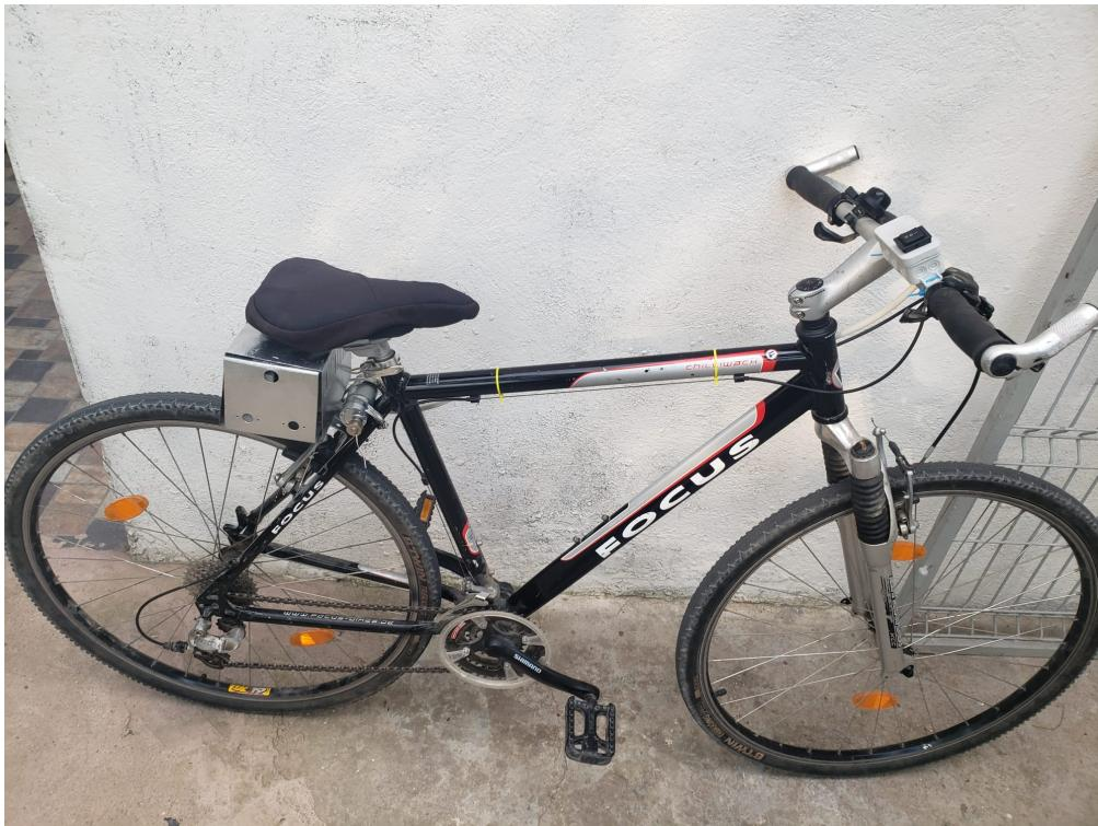
Se observa in partea din fata intrerupatorul care comanda momentan schimbarea vitezei, sub sa cutia in care se afla bateria de 12V (de dimensiuni cam mari, dar este doar un prototip ), iar intre cutie si cadru motorul care infasoara/desfosoara cablul care duce la deraior.
