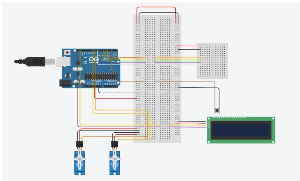
Breadboard-ul mini din partea dreapta reprezinta Color Module-ul, deoarece nu exista pe Tinkercad; unde pinii 4, 5, 6, 7, 8 din Arduino sunt conectati la pinii S0, S1, S2, S3, OUT de pe TCS230.
