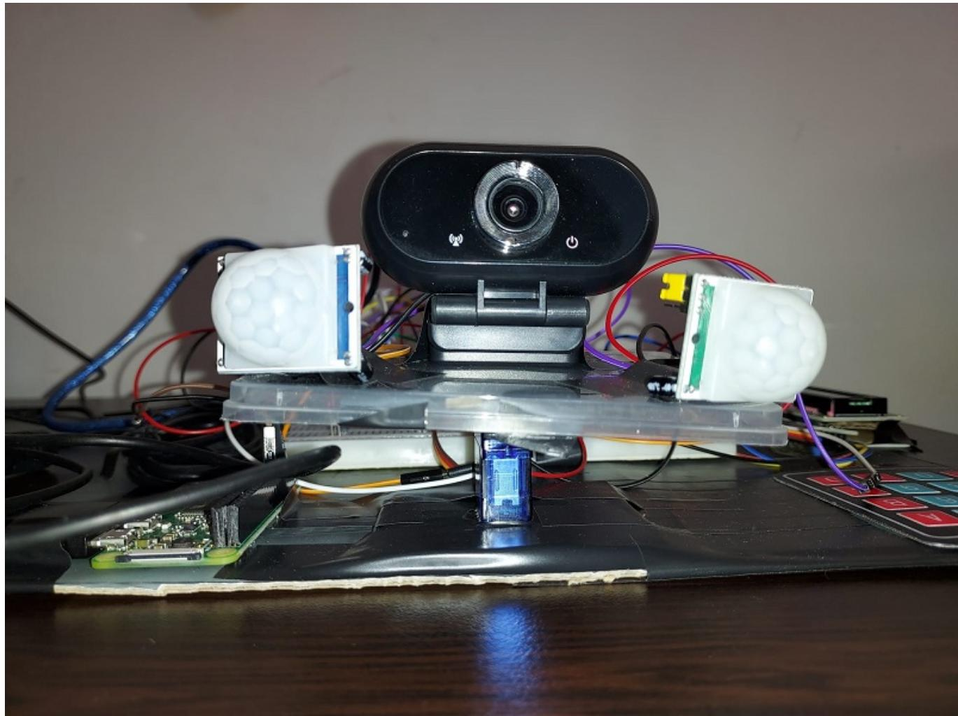
La finalul implementarii proiectului in format fizic, acesta indeplineste toate functiile descrise. Cu ajutorul celor 2 senzori PIR de miscare asezati astfel incat unghiurile lor de actiune sa nu se intrepatrunda decat intr-o portiune bine stabilita, intrusul este detectat, camera este rotita catre directia miscarii receptate, iar buzzerul impreuna cu ledul care lumineaza intermitent activeaza.
