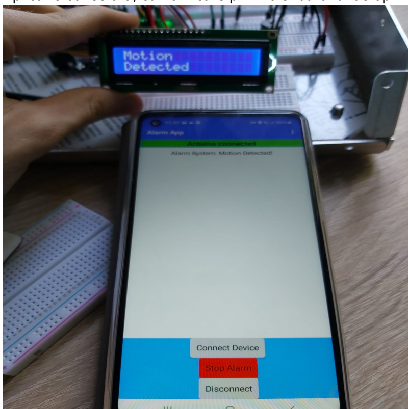
Aplicatie conectata, cu notificare primita si butonul de oprire a sistemului activ.
