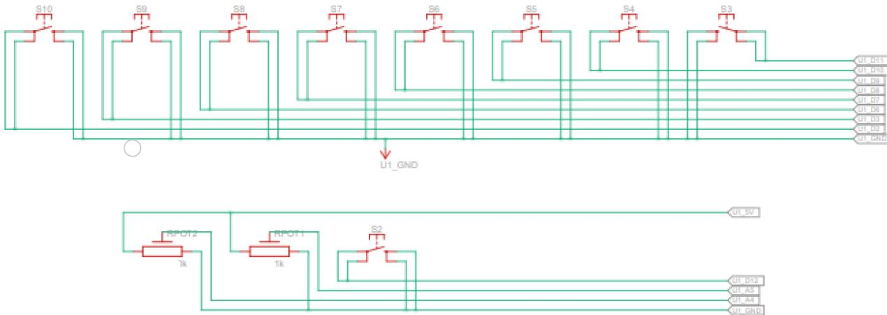
A doua imagine descrie conexiunile clapelor, butoanelor de control si potentiometrelor de control ale pianului cu placuta Arduino. Cele 7 clapе sunt conectate la pinii digitali de la 6 la 12, cele doua butoane de control la pinii digitali 2-3, iar potentiometrele la pinii analogici A4-A5 (18-19). Imaginea intreaga de ansamblu a schemei electrice este disponibila in sectiunea Download.
