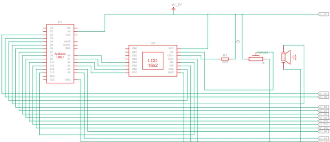
In prima imagine sunt descrise conexiunile placii Arduino cu ecranul LCD (respectiv rezistorul si
