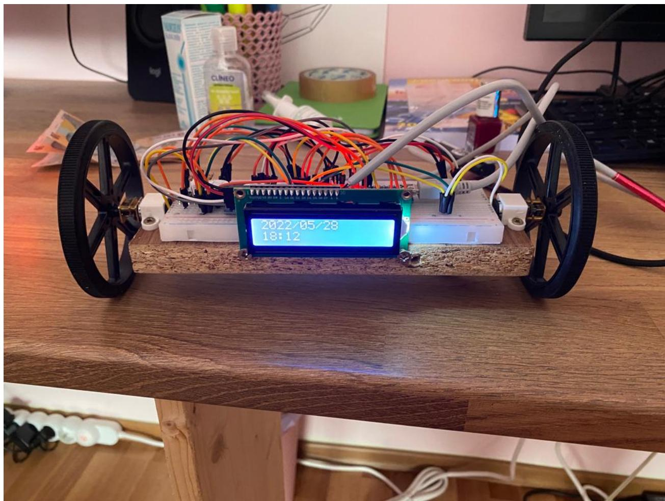
In forma finală, proiectul are oficial funcționalitatea completă a unui ceas cu alarmă pe roți. Din pacate, datorită lipsei unui mod eficient de balansare al acestuia, după un scurt timp de la pornirea rotilor, modulul central se va lăsa pe fata și va interupe rotatia rotilor.
