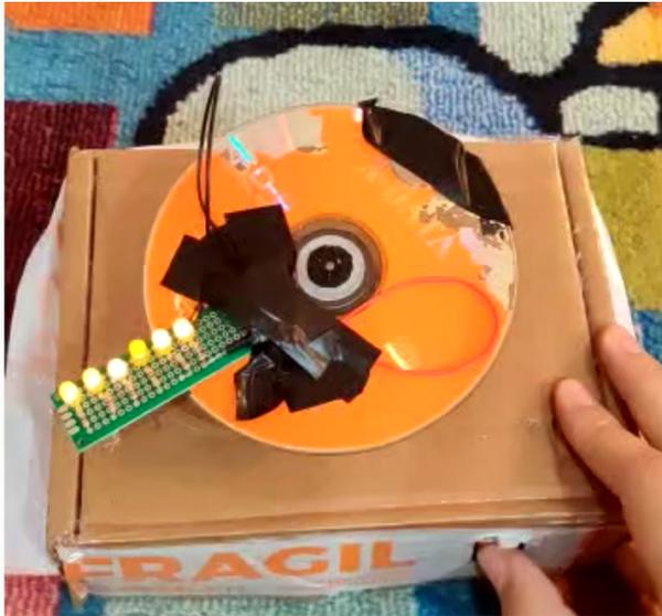
Deși motorul era suficient de puternic pentru a roti CD-ul cu LED-urile și cu placuta Arduino, atunci când adăugăm bateria de 9V nu mai făcea față și rotea destul de încet. O altă alternativă încercată a fost un ventilator de PC, însă nici el nu avea suficient cuplu.
