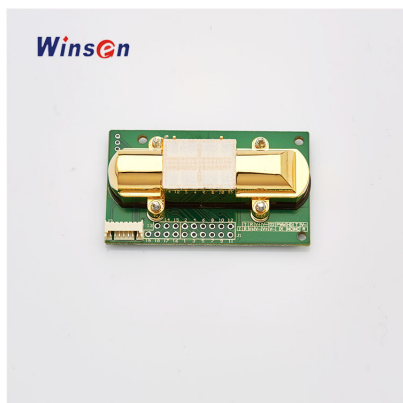
MH-Z14A NDIR CO2 Sensor
