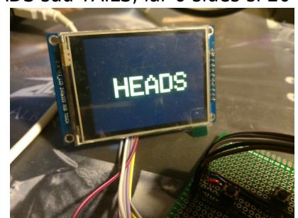
Modul custom emuleaza intr-un mod diferit aruncatul cu zaruri cu intre 2 si 9 fete folosind keypad-ul. In acest mod se asteapta apasarea unei taste de pe keypad. Cat timp va fi tinuta apasata pe ecran vor aparea rapid numere random din range-ul corespunzator tastei apasate. La ridicarea degetului de pe tasta pe LCD va ramane afisata valoarea aruncarii respective.
