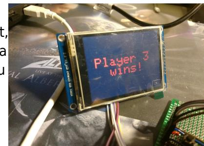
Atunci cand ramane in joc un singur jucator, acesta va fi castigatorul, veti fi dusi intr-un winning screen unde se va scrie mare pe LCD player-ul care a castigat meciul respectiv si se va canta un cantecel de victorie din buzzer. Din acest winning screen se va iesi apasand butonul 0 si veti fi intorsi la meniu principal. De acum, cand se vor selecta optiunile "Standard" sau "Commander" va aparea iar cererea pentru numarul de jucatori si se va crea un joc nou.
