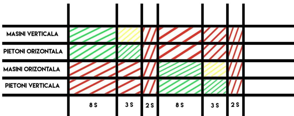
In cazul in care numarul este inegal, se va face verde acel semafor la care sunt mai multe masini. Acest lucru se va detecta prin masurarea luminii din sala si compararea ei cu lumina masurata la fiecare semafor de masina. Acest semafor va sta verde 8 secunde, dupa care se va verifica din nou numarul de masini sau daca a fost apasat butonul pentru pietoni de la celalalt set de semafoare.
