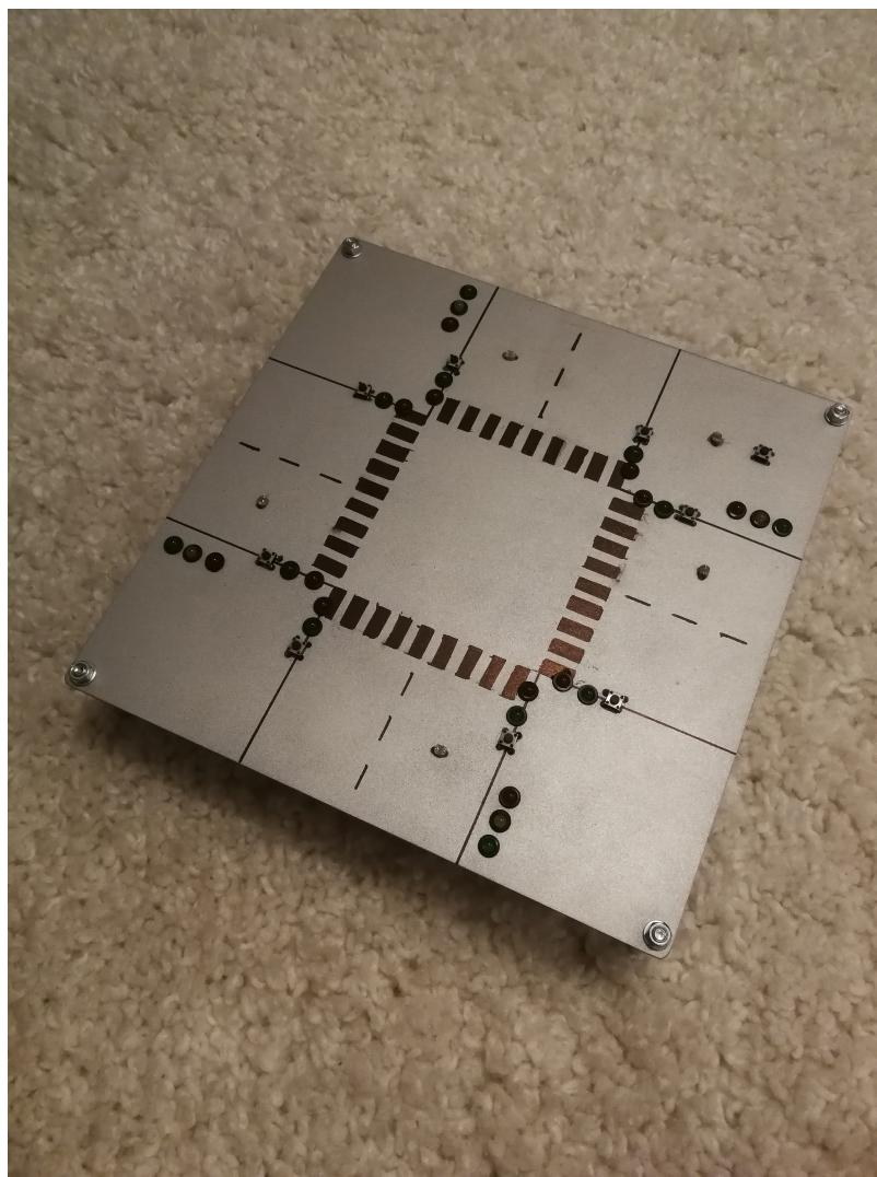
Mai sus se poate observa Hardware-ul final, compus din 2 placi de plexiglas, cea de sub fiind transparenta pentru a se putea observa cu usurinta firele.
