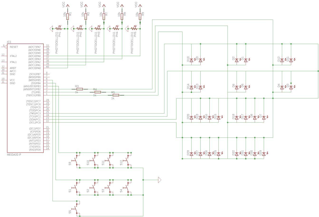
Fotorezistorii au fost conectati la porturile PA0..4, iar butoanele la porturile PB3..5.
