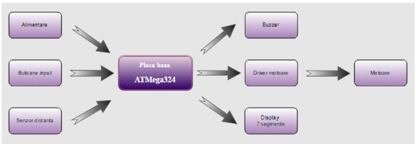
Utilizatorul va interactiona cu dispozitivul prin intermediul a 5 butoane care vor trimite datele la ATmega324: setare ora, setare minut, oprire alarma, ceas, alarma.
