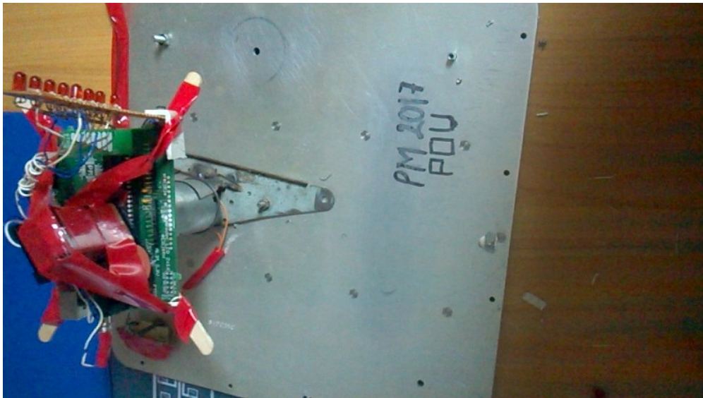
Bateria de 9V am prins-o cu banda izolatoare de capetele betisoarelor
