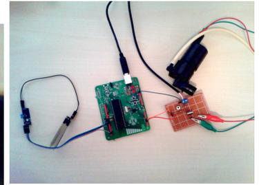
Am reușit să termin proiectul în varianta pe care mi-am propus-o, la care am adăugat și un buton prin a cărui apăsare se poate porni pompa oricând, chiar și dacă pământul nu este suficient de uscat pentru a se declanșa automat pornirea pompei.
