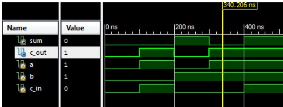
Diagrama semnale pentru full adder
