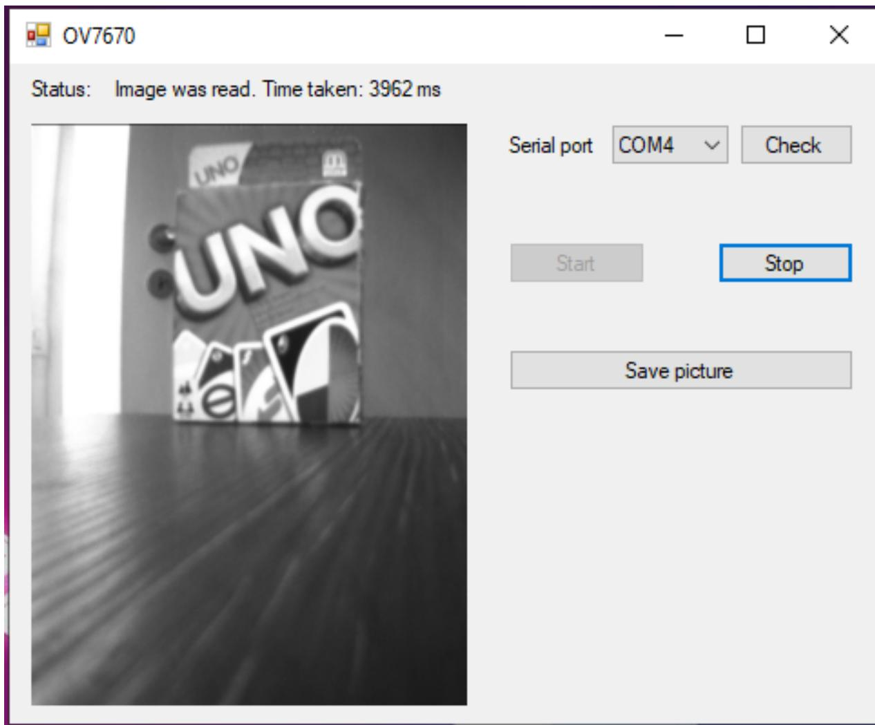
Acesta este unul dintre modurile de afisare al rezultatelor: un applet care porneste un listener pe COM4 si transforma bitmap-ul primit pe seriala intr-o imagine.
