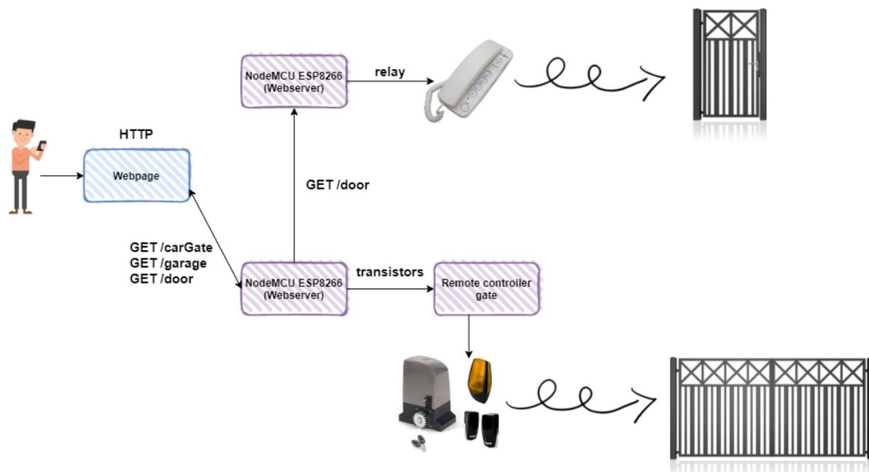
Device-ul din partea de sus, conectat la interfon, va fi referit in continuare prin **Device interfon**, si reprezinta un server care asculta pe /door si activeaza un releu.
