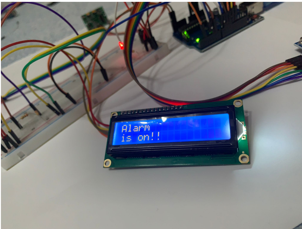
Senzorul PIR detectează mișcare și se va trimite notificare pe telefonul mobil:
