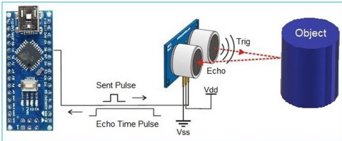
La broche d'écho est rendue haute pendant le temps d'envoi d'une impulsion haute. Et la distance du faisceau peut être calculée à l'aide de la formule de distance de la physique de base qui est donnée par
