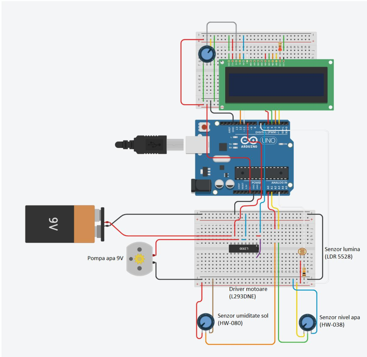
Pe breadboard-ul pe care am montat lcd-ul, se afla un potentiometru folosit pentru a ajusta contrastul ecranului. Este singura "componenta" a sistemului controlata hardware.
